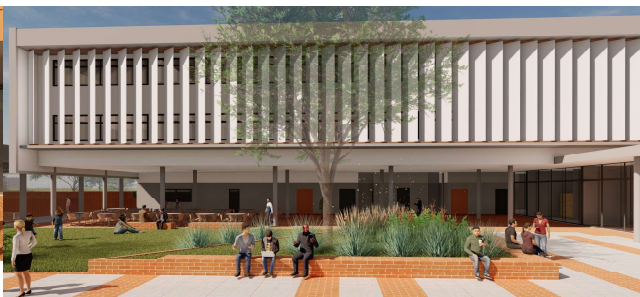
Brises barrando a incidência solar direta na fachada do bloco de salas de aula, conforme previsto pelo estudo apresentado. Promovem dinamismo e ritmo a fachada, deixando da demarcação das janelas em fita em segundo plano.
